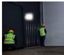
マグネットでは鉄骨などに設置可能
